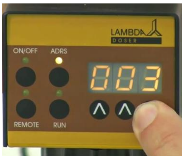
Рисунок 2-6: Выберите нужный период времени для первого шага программы, нажимая на кнопки ▲▲▲ под дисплеем (от 0 до 999 минут или 00,0 до 99,9 минут). Нажатием кнопки ADRS можно установить временное разрешение в минутах или 0,1 минут. Временное разрешение в 0.1 минут будет отображаться с точкой, например, "00.1".
