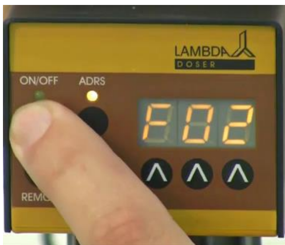
Рисунок 2-7: После нажатия на кнопку ON / OFF на дисплее на короткое время появится обозначение "F02".
