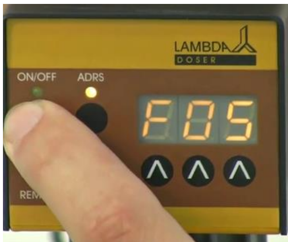
Рисунок 2-11: После того как вы установили желаемое временное значение для последнего шага, нажмите кнопку ON/OFF . На дисплее появится скорость потока (000) следующего шага, который Вы ещё не запрограммировали, например: “F05”
