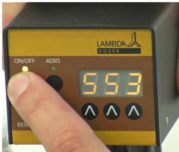
Рисунок 1-14: После выбора скорости дозирования нажмите кнопку ON / OFF на блоке управления.
