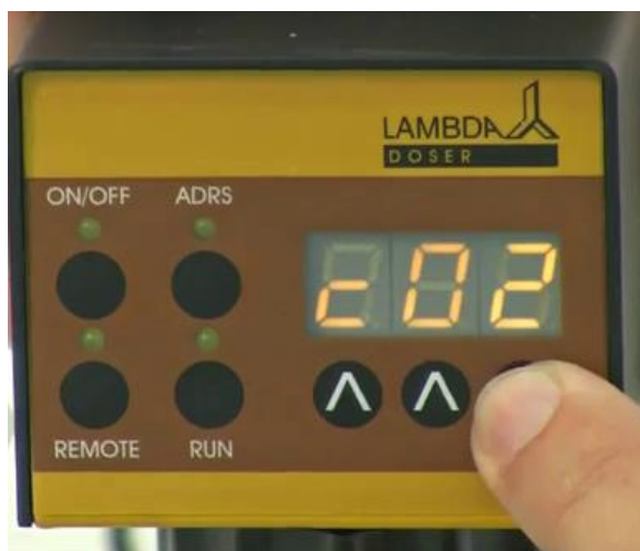
Рисунок 2-14: Если вы хотите, чтобы программа была повторена дважды, увеличьте число циклов до “c02” , нажимая на кнопки Λ Λ Λ под дисплеем (от 0 до 99 циклов). Программу можно повторять до 99 раз, обозначенных “c99” Если ввести 0 в цикловой номер “c00” , программа будет работать непрерывно ( бесконечный цикл ).
