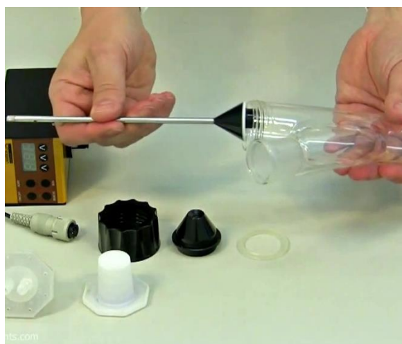
Рисунок 1-4: Вставьте распределитель (стандартный) в стеклянный сосуд (~ 0,2 л) отверстием вниз, чтобы избежать повреждения.
