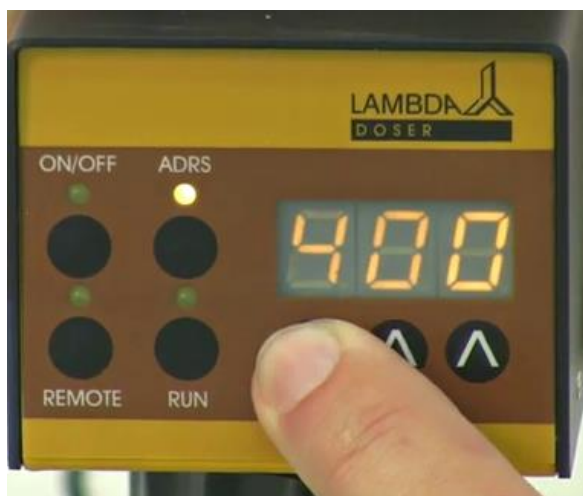
Рисунок 2-4: Установите требуемое значение скорости потока для первого шага программы, нажимая на кнопки ▲▲▲ под дисплеем (от 0 до 999, что соответствует скорости вращения двигателя от 0 до 100%).
