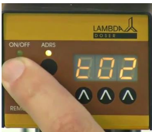
Рисунок 2-9: При повторном нажатии на кнопку ON/OFF на дисплее ненадолго появится символ "t02".
