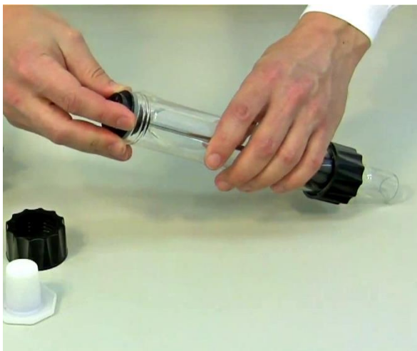
Рисунок 1-7: Наденьте центрирующий элемент с резиновым уплотнением на ось распределителя.
