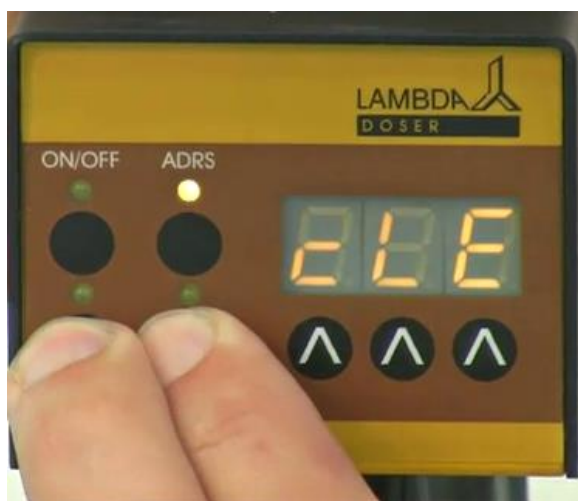
Рисунок 2-2: Если вы продолжите нажимать кнопки Remote и Run после того как на дисплее появится "PGM", далее появится обозначение "cLE".
