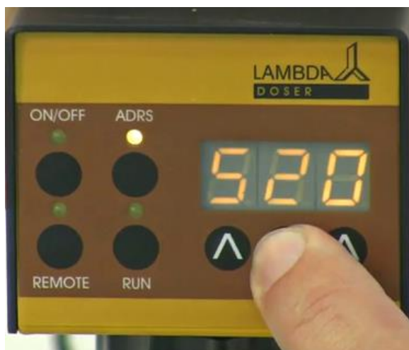
Рисунок 2-8: Введите желаемую скорость потока для второго шага программы.
