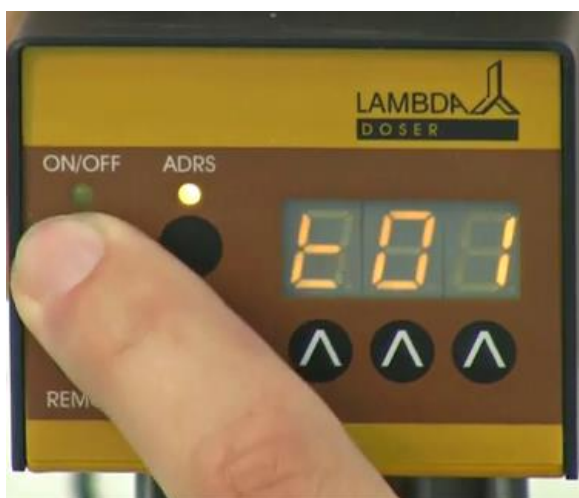
Рисунок 2-5: При нажатии на кнопку ON / OFF на дисплее на несколько секунд появится обозначение " t01 ", указывая на то, что вы можете запрограммировать временной период первого шага с шагом в минутах или в 0,1 минут
