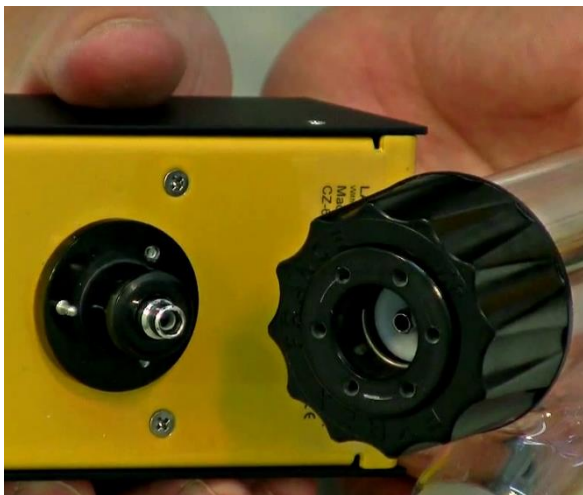
Рисунок 1-9: На рисунке изображен моторный блок с металлическими штифтами и центрирующая часть с шестью отверстиями.
