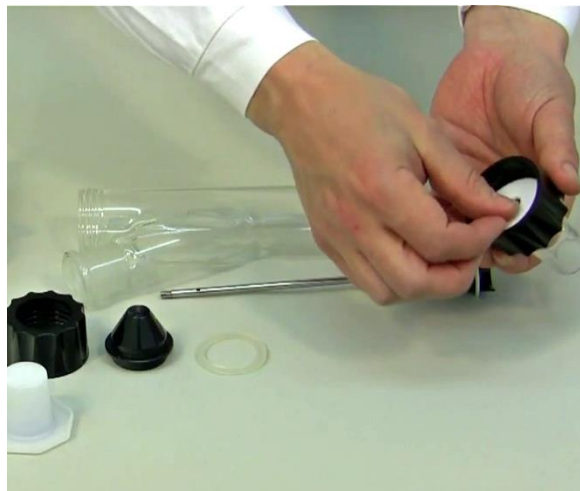
Рисунок 1-2: Поместите тефлоновый диск внутри винтовой крышки в верхней части стеклянного адаптера (NS 29/32).
