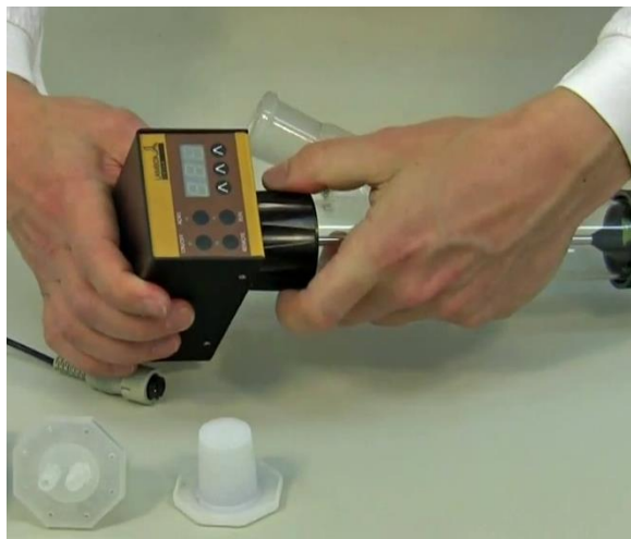
Рисунок 1-10: Поместите моторный блок в центрирующую часть так чтобы штифты совпали с предназначенными для них отверстиями. Должен раздаваться лёгкий щелчок. Это обеспечит полную герметизацию дозаторной установки и оптимальное давление распределителя на тефлоновый диск в нижней части стеклянной трубки.
