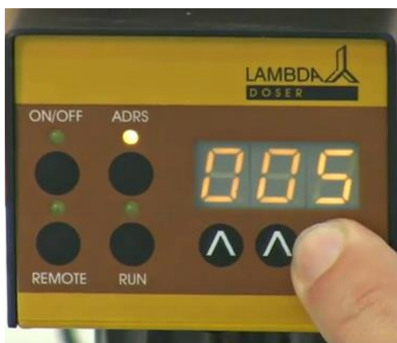
Рисунок 2-10: Установите время для второго шага программы.
