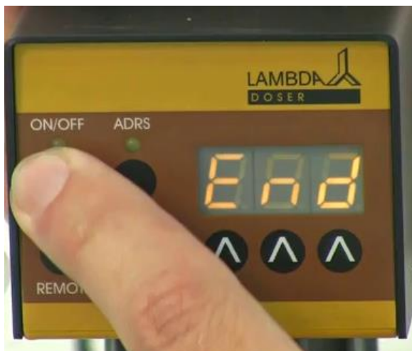
Рисунок 2-15: Снова нажмите кнопку ON/OFF пока на дисплее не появится обозначение “End” , чтобы сохранить программу.
