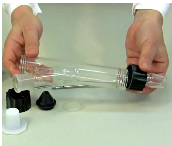
Рисунок 1-3: Наденьте винтовую крышку с тефлоновым диском на стеклянный сосуд, ёмкостью 0.2л и закрутите по резьбе.
