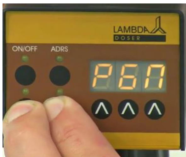
Рисунок 2-1: Одновременно нажмите кнопки Remote и Run и удерживайте их пока на дисплее не появится обозначение "PGM".
