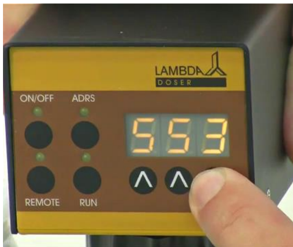
Рисунок 1-13: Скорость добавления порошка можно установить с помощью кнопок управления \wedge \wedge \wedge
