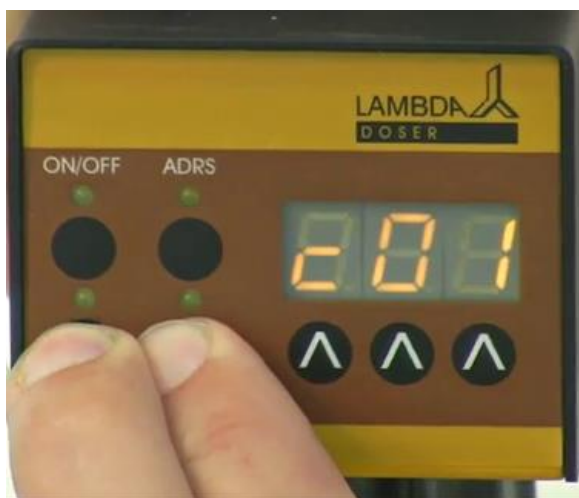
Рисунок 2-13: При одновременном нажатии кнопок REMOTE и RUN на дисплее появится символ “c01” Это означает, что программа будет выполнена только один раз и прибор дозирования после этого остановится.
