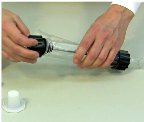
Рисунок 1-8: Центрирующий элемент с резиновым уплотнением и осью распределителя прикрутите завинчивающейся крышкой к стеклянному сосуду.
