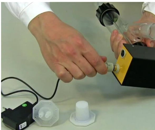
Рисунок 1-11: Вставьте 12 В разъем блока питания в гнездо моторного блока и включите блок питания в сеть. Должен раздаваться акустический сигнал и зажегнется табло дисплея.
