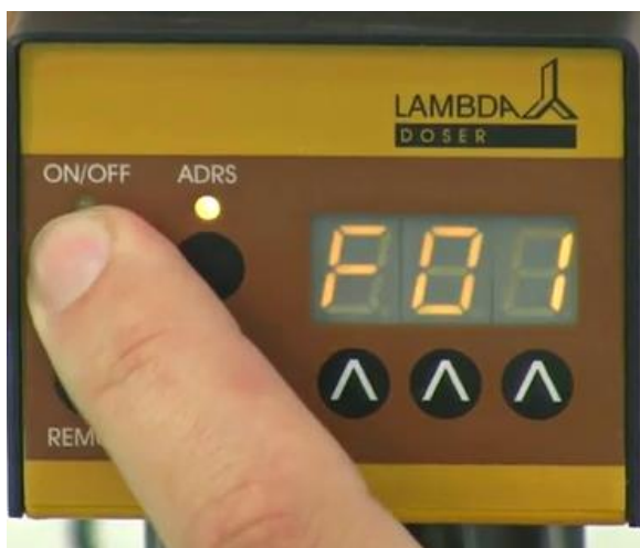
Рисунок 2-3: После нажатия на кнопку ON / OFF на дисплее на короткое время появится обозначение "F01", указывая на то что вы можете установить первую скорость потока (установка скорости).
