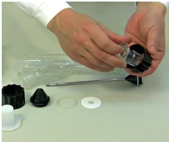
Рисунок 1-1: Наденьте винтовую крышку SVL 42 на стеклянный адаптер в.
